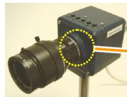
PhCフィルター内蔵 マルチスペクトルカメラ
