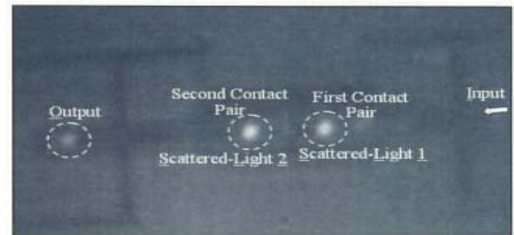
図5 アクチュエータに45Vの電圧を印加して中間シリコン細線導波路を移動させた時の赤外線顕微鏡写真。
