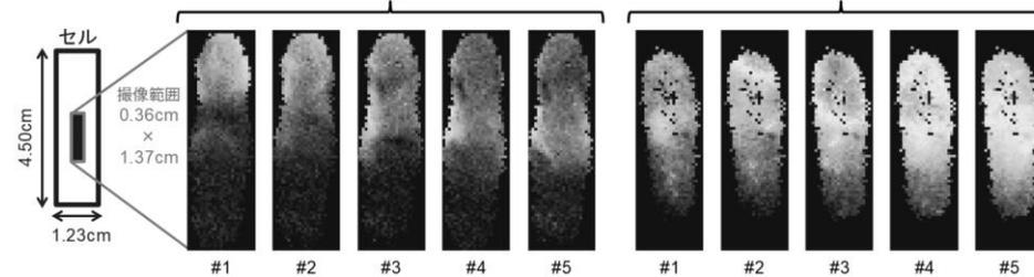
5mg/dLグルコース溶液をイメージングした例(透過波長として960,1050nmを選択)
