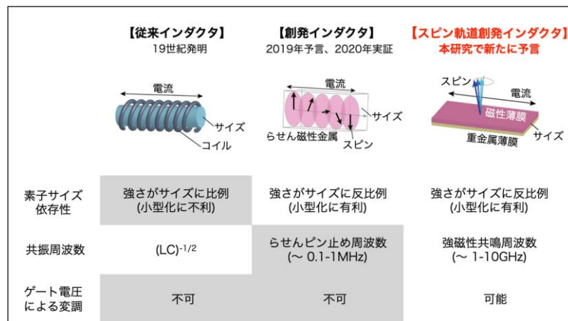
図1 発明者の研究で予言されたスピントロニクス開発インダクタと、これまで知られていたインダクタの比較 (LとCはそれぞれ、コイルのインダクタンスとキャパシタンス)
