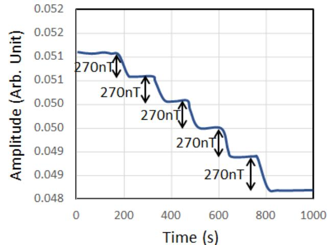
直流外部磁場を増やすと振動振幅は低下(位相(不図示)は増加)しているのが、階段状の応答から見る事ができる。
